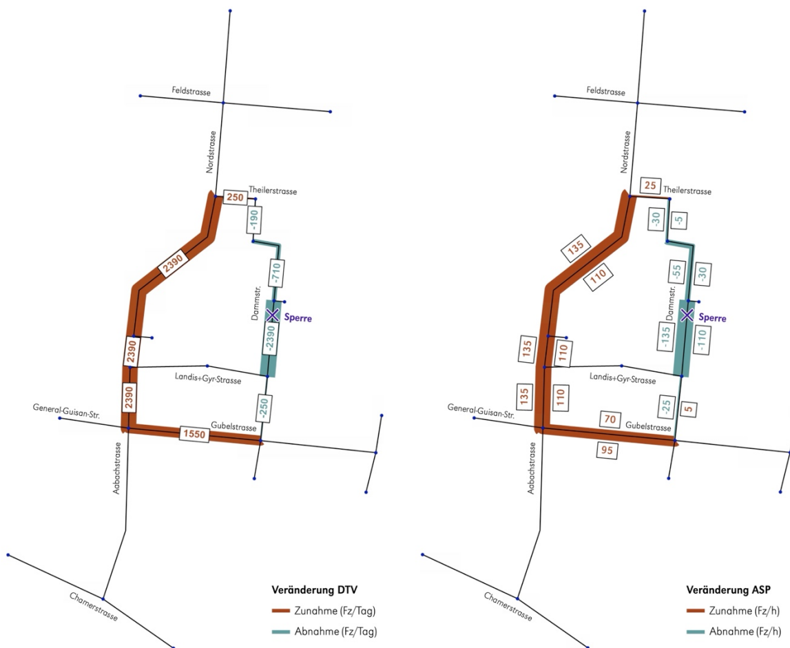
Abbildung 19: Veränderung der Verkehrsbelastungen durch die Sperre der Dammstrasse (DTV links, ASP rechts)
